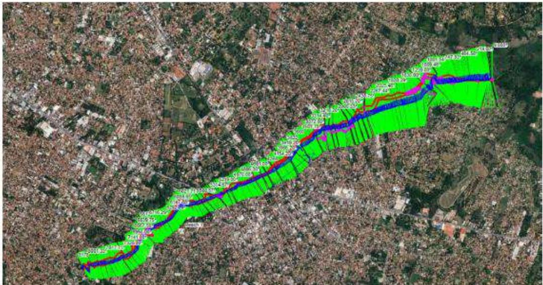
Figura 27. Secciones transversales del modelo hidráulico
